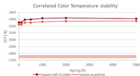
L'aperçu dans le tableau ci-dessus montre les résultats d'un certain nombre de mesures effectuées avec Dowsil EI-2888 dans différentes épaisseurs de couche avec différentes LED. Il est clairement visible que l'épaisseur de la couche de résine coulée influence le changement de couleur de la LED. Nous pouvons également conclure que l'épaisseur de la couche de résine coulée a une influence majeure sur toute perte de lumière dans une application.
